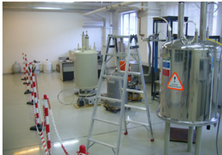
Abbildung 2.4 – Abgrenzung des Sperrbereichs durch eine Kettenabspernung und Bodenmarkierungen
