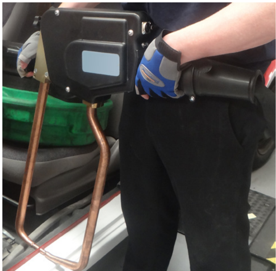
Abbildung 6.5 – Die X-Schweißzange der Karosseriereparaturwerkstatt mit befestigten 550-mm-Elektroden. Die beiden Elektroden werden durch einen Kolben im Zylinder der Zange (zwischen den Händen des Arbeitnehmers) gegeneinander gepresst, außerdem enthält der Zylinder den Transformator, der den Schweißstrom liefert.
