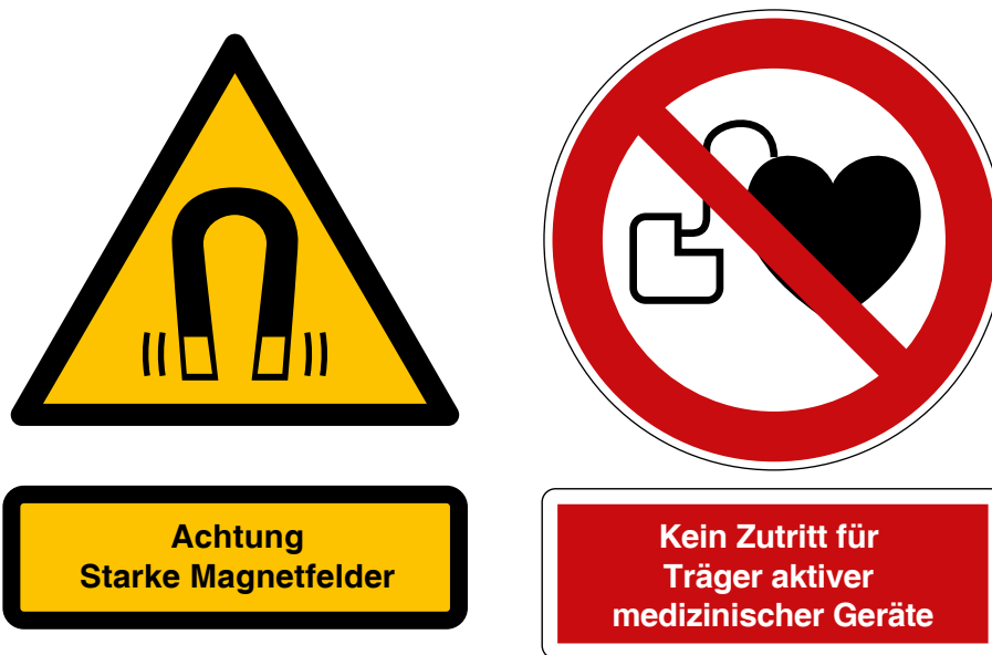
Abbildung 8.6 – Beispiel für einen Warnhinweis am Zugang zu bestimmten Arbeitsbereichen
