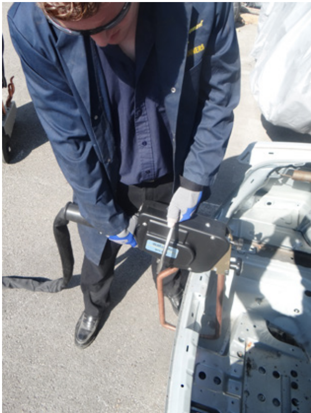
Abbildung 6.1 – Verwendung eines Handpunktschweißgeräts zur Befestigung einer neuen Blechtafel
